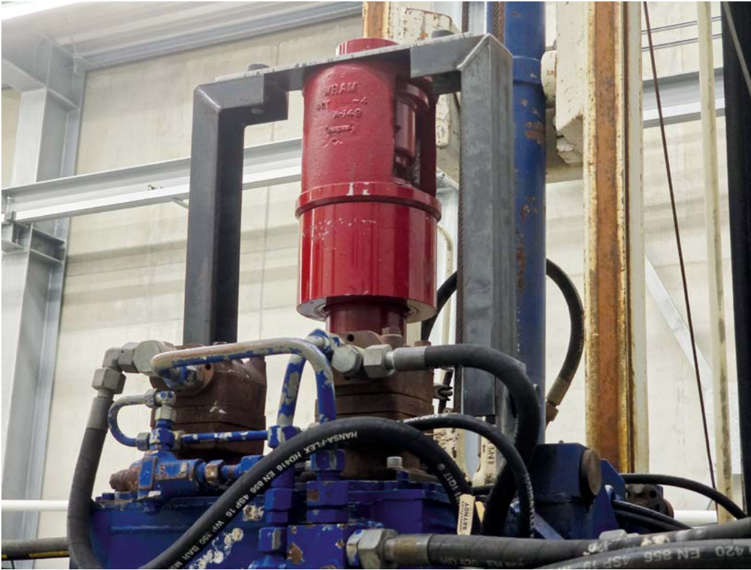
Abbildung 4: Modifikation am mobilen Bohrgerät zum Anschluss an den Flow Loop des DSC.
